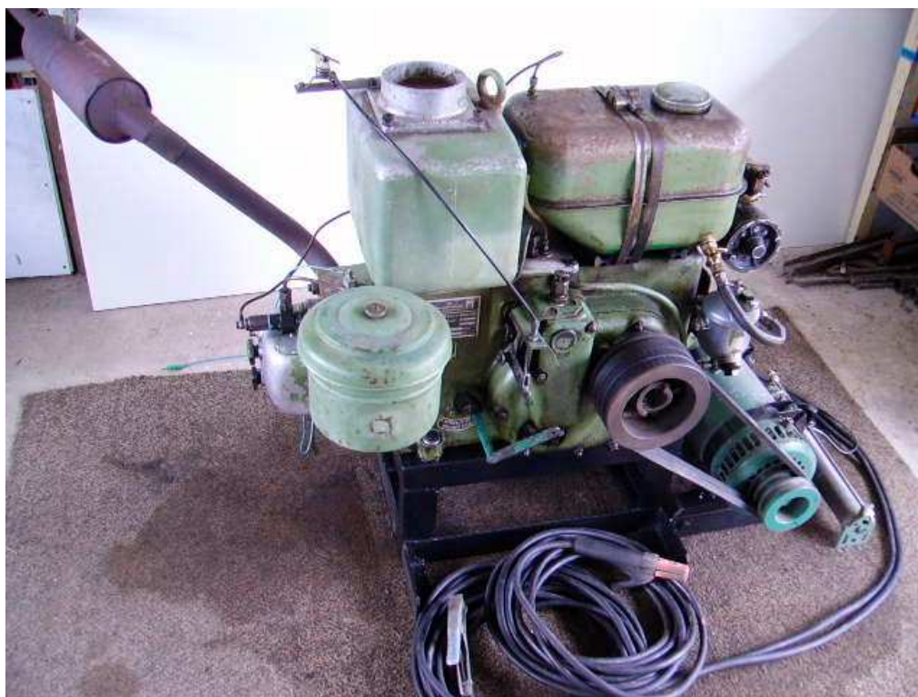
Obr. 5, 6: Hotová svářečka, ještě bez zapojené tlumivky.
