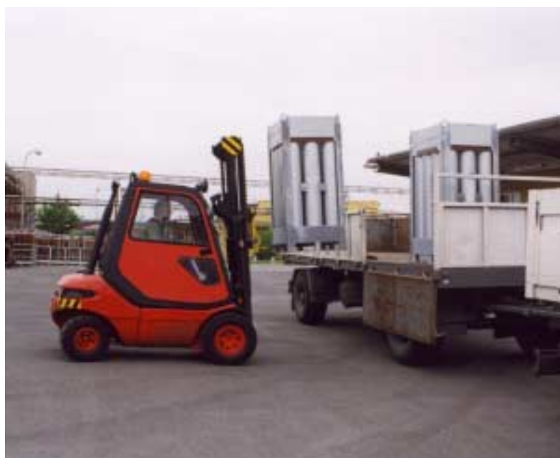
Obr. 17: Manipulace se svazky lahví oxidu uhličitého
