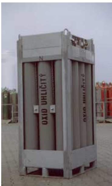
Obr. 7: Svazek lahví pro oxid uhličitý
