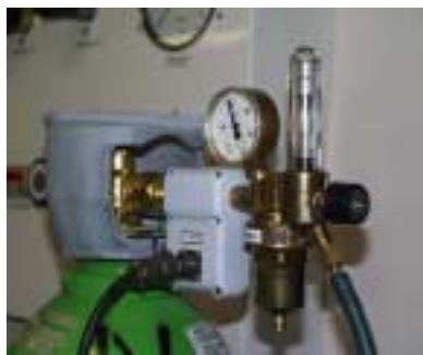
Obr. 8: Lahvový redukční ventil pro oxid uhličitý s vyhříváním
